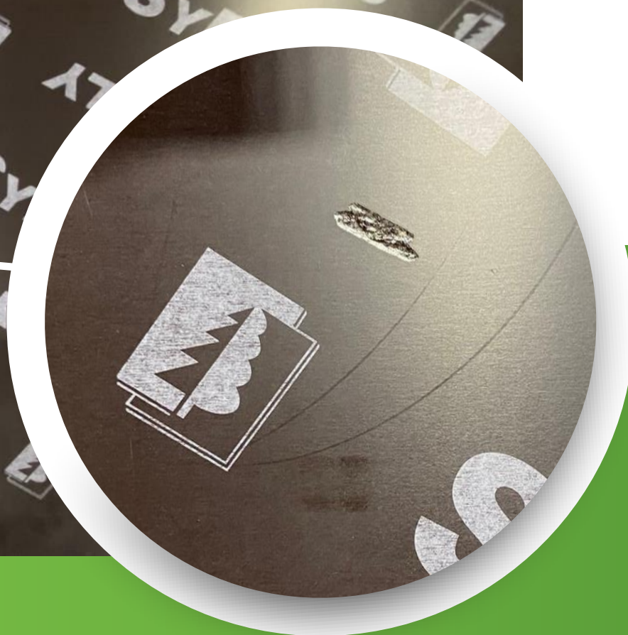
Прогар по недоработанному дефекту (вмятина)
